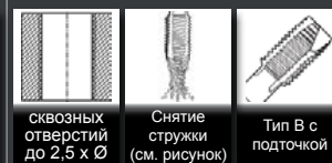
сквозных отверстий до 4 x Ø Снятие стружки (см. рисунок) Тип В с подточкой
